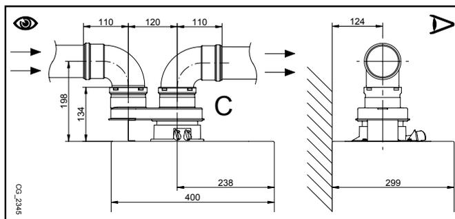
90° отвод позволяет присоединять котел к дымоходу-воздуховоду в любом направлении, адаптируясь к различным требованиям. Кроме того, он может использоваться в качестве дополнительного в сочетании с трубой или с 45° отводом.
